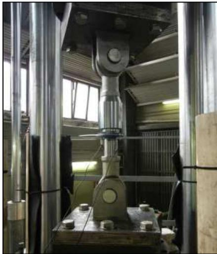
Fig.12 – A single fuse element in test rig in Politecnico di Milano
