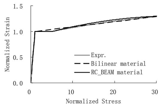
(d) Material models for beam element
